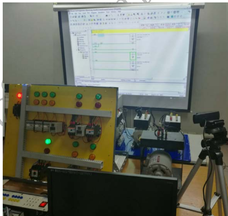
ภาพที่ 20 การทำงานจริงของห้องปฏิบัติการเรียนรู้ศูนย์กลางทางไกลในการปฏิบัติงานการควบคุมเครื่องจักรไฟฟ้าแบบมีส่วนร่วม เมื่อมีการสั่งการทำงานของโปรแกรม
