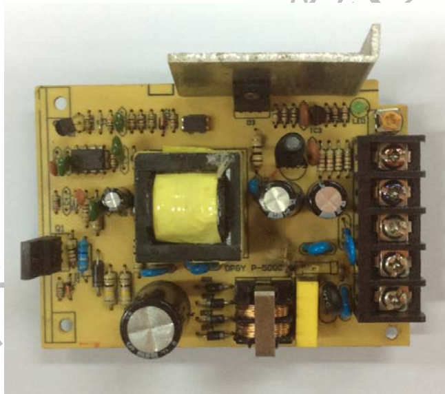
ภาพ 64 ภาพถ่ายจริงวงจรฟลายแบ็ค คอนเวอร์เตอร์ ขนาดกำลัง 50 W ที่ใช้ทดสอบ
