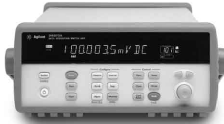
ภาพที่ 3.9 อุปกรณ์เก็บข้อมูล AGILENT 34970a BENCHLINK DATA LOGGER
