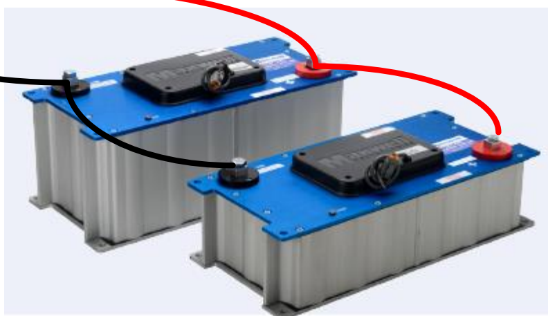
(ข) การต่อขนานซูเปอร์คาปาซิเตอร์ขนาดพิกัดรวม 330 F, 48 V
