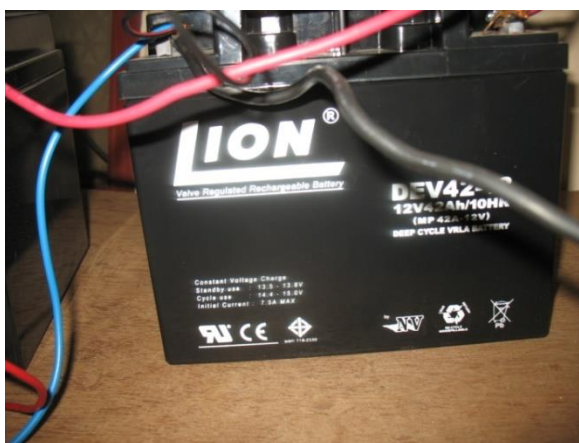
ภาพที่ 3.4 แบตเตอรี่ LION ขนาดพิกัด 12 V, 42 Ah
