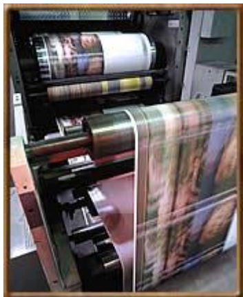
ภาพที่ 8 การพิมพ์ออฟเซตชนิดม้วน www.thecreativeguide.com/logoivo [12 ธันวาคม 2558]
