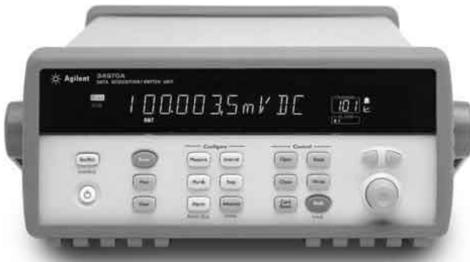
ภาพที่ 3.13 อุปกรณ์เก็บข้อมูล AGILENT 34970a BENCHLINK DATA LOGGER
