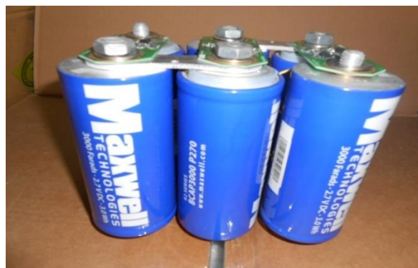
ภาพที่ 3.9 แสดงการต่อซูเปอร์คาปาซิเตอร์ 500F 16.2V
